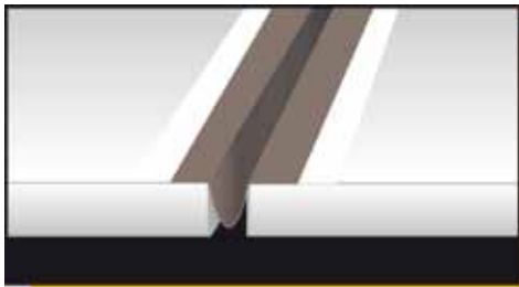
Poziționarea produsului Mapeband PE 120 sub formă de litera omega, într-un rost de dilatare
