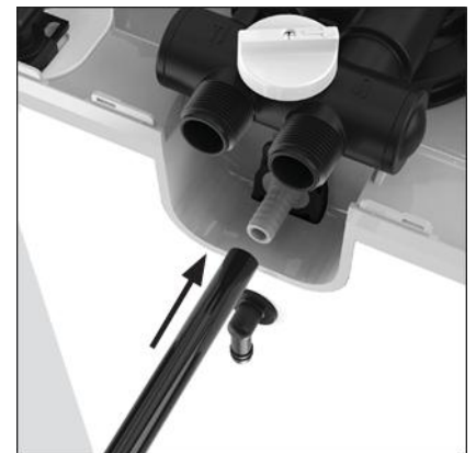
Figura 6: Montarea furtunului de drenaj
