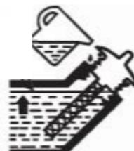
Scoateți bușonul rezervorului de ulei, se alimentează numai cu uleiul corespunzător. Pentru cantitățile de alimentare consultați secțiunea parametrilor și specificațiilor tehnice ale utilajului. Folosiți pâlnia de umplere iar în cazul vărsării accidentale curățați solul pentru a evita alunecarea.
