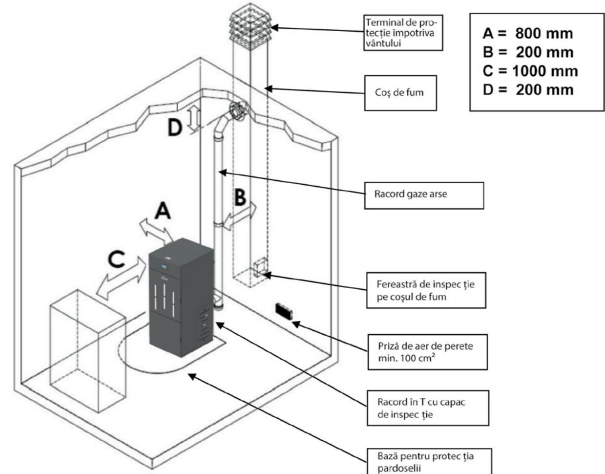
Instalația trebuie astfel realizată încât să permită accesul ușor pentru operațiile de întreținere periodică.
