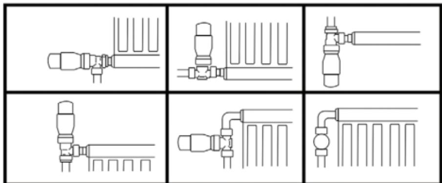
*Nota: PNI CT25T se poate monta doar pe robineti termostatati. Nu functioneaza cu robineti clasici de calorifer.*
