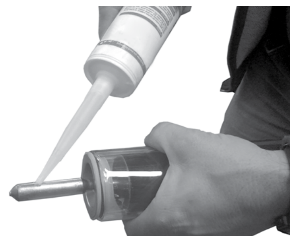
Adăugați rășina termoconductoare pe condensatorul țevii heat-pipe.
