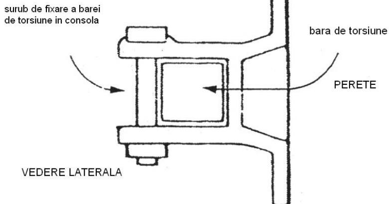
Pentru a calcula inaltimea de montare a consolelor trebuie sa se tina cont de unghiul de inclinare a bratelor de sustinere a copertinei care este cuprinsa intre 1-2 '' pe picior de extindere.
