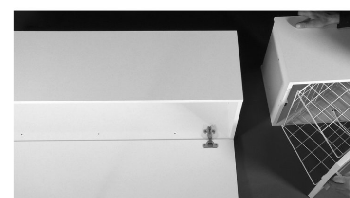
20 - Se cupleaza corpul inferior si corpul superior.
