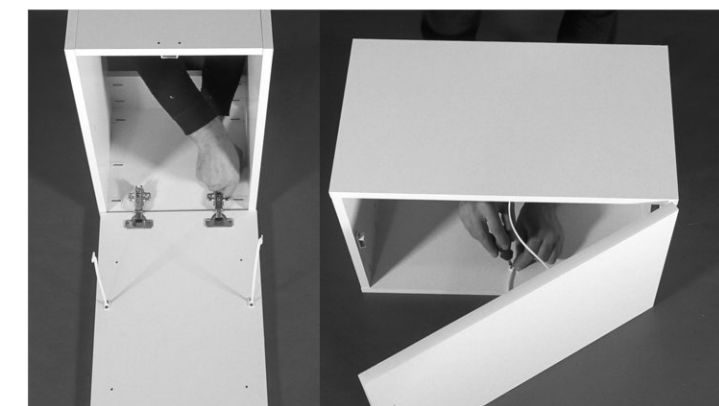
7 - Se monteaza usa. Se prind limitatoarele de cursa si de lateralul corpului inferior.
