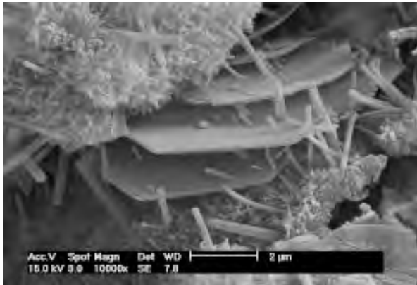
Hidratarea liantului pe baza de ciment Portland la un mortar traditional pentru rosturi
