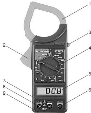
Figura 1 — Elementele panoului frontal al cleștelui ampermetric
