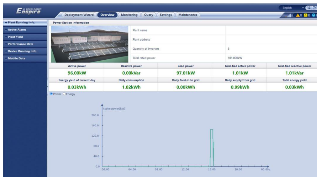
Figura 6-3 Informații despre funcționarea instalației (cu contor de putere, dar fără baterie)
