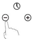
1.2 Ajustați setarea temporizatorului atingând tastele „ $\wedge$ ” sau „ $\vee$ ”. Pe display-ul temporizatorului va apărea indicatorul de minute.
