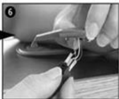
5 introduceți linia audio în mod corespunzător și instalați ușor doza în mufă.
