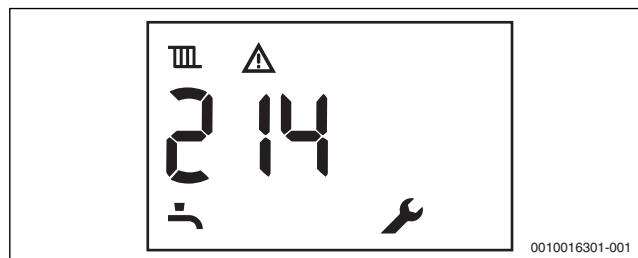
Fig. 69 Exemplu: defecțiune care nu determină blocare
